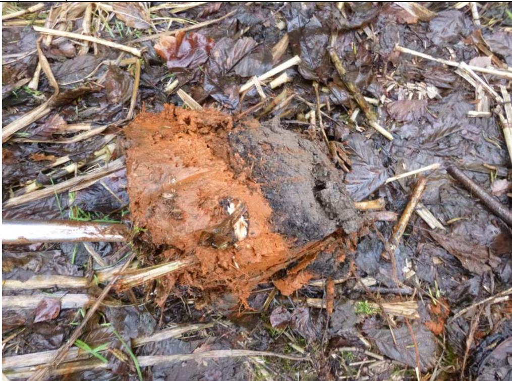
Foto 4: Eisenoxidausfällung im Oberboden um Schacht Q4
